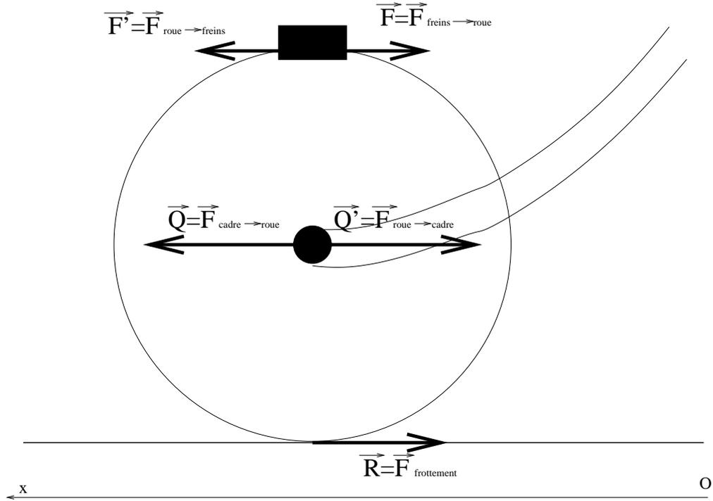
FIG. 3 – Figure des forces appliquées sur la roue et sur le cadre
